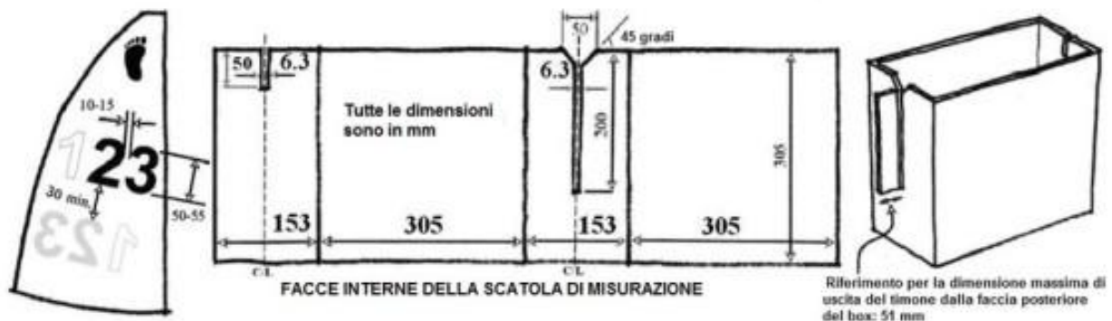
Рис. Знаки класса Footy на парусе и измерительный шаблон
